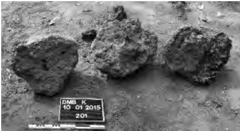
Fig. 19 Trois blocs de scorie interne provenant de l'amas de scories du fourneau K-201 (zone de Doumbala Kokoroni, tradition technique KAN 2D). Ces blocs pèsent entre 70 et 100 kg.
