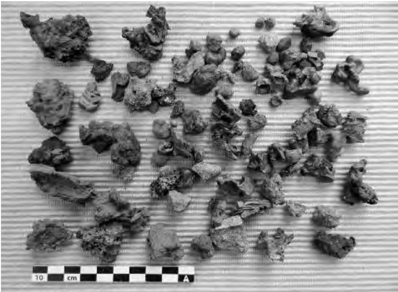
Fig. 35 Petits fragments de scories et débris de minerai incomplètement réduit provenant de la partie inférieure du remplissage de la cuve du fourneau V-102 (zone de Doumbala-Village, tradition technique KAN 3D).
