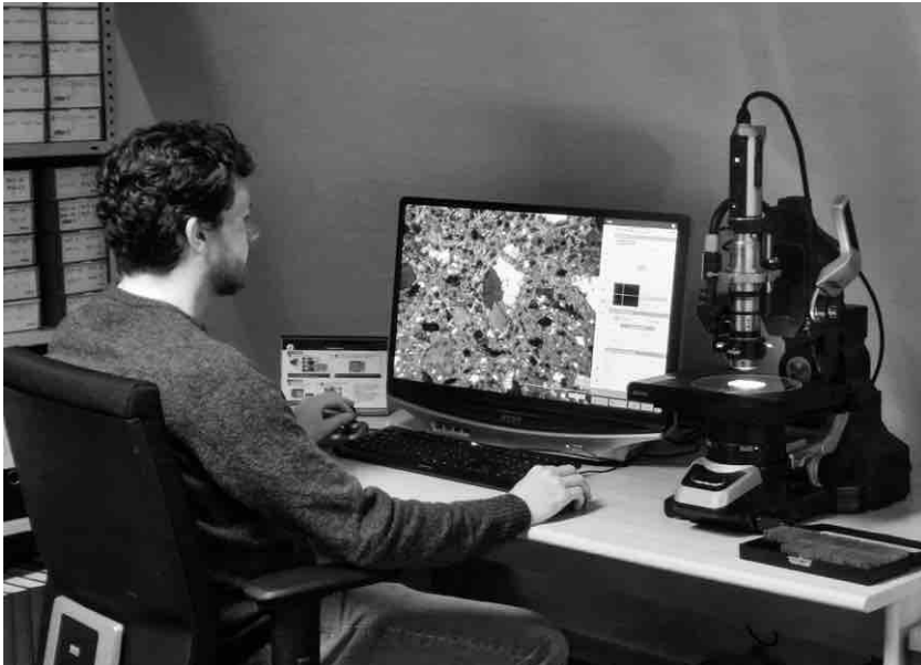
Abb. 23 Analyse von Keramikdünnschliffen mit einem hochauflösenden digitalen Mikroskop (Foto: J. Langmann)
