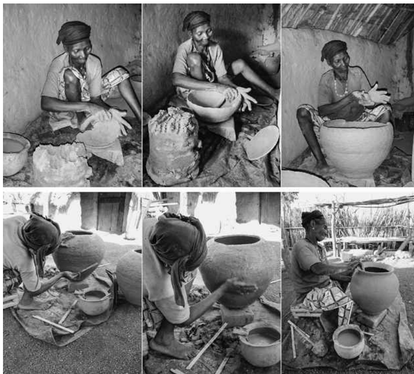
Fig. 45 Façonnage par écrasement de colombins en spirale chez les Peul Tamgué, village de Dianhéri 2018 (photos A. Mayor)
